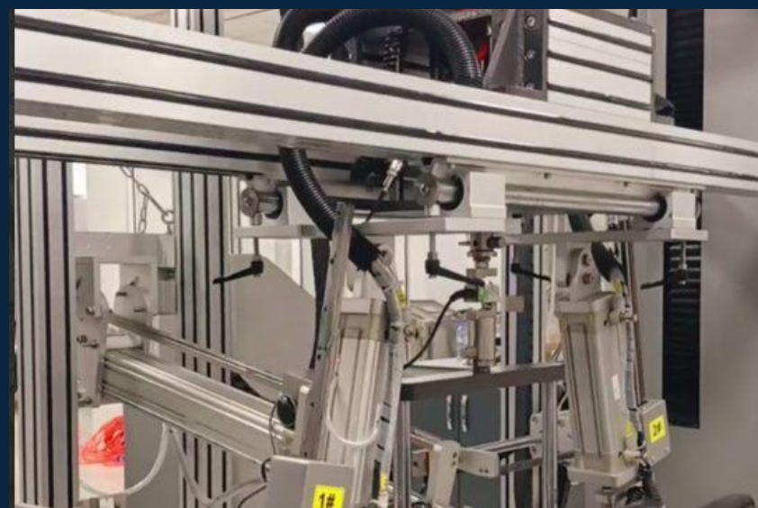
Циклические испытания офисных стульев
